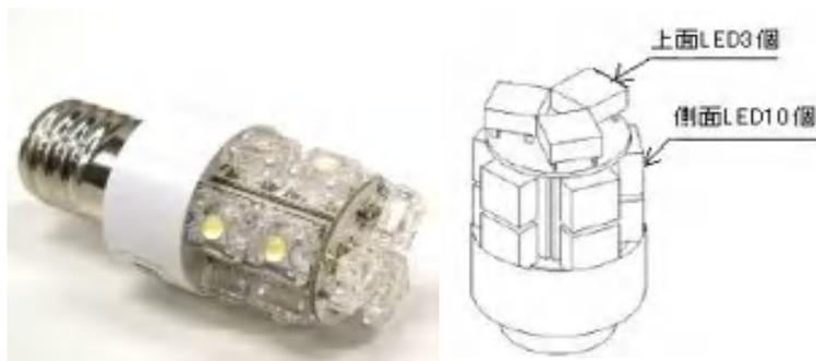
JEC\_LED電球はAC100Vに対応した電球型LEDランプです。円柱状のランプ側面に10個、ランプ上面に3個の合計13個のFluxLEDを使用しており、白熱電球のように全体にLED光源を発光します。LED電球はLEDの性質上光の指向性が強く、スポットランプの電球が主流でしたが、広角LEDを側面に実装することで全体的に発光するように設計されました。発光色は赤、青、黄(アンバー)、緑(※1)、白、電球色の6色。ソケットは用途が多い口金17とE26の2種類です。透明感あるLED光源を活かした室内のインテリア照明やイベント等のサイン照明としてお勧めです。また、この製品は防水仕様ですので野外にもご使用いただけます。
